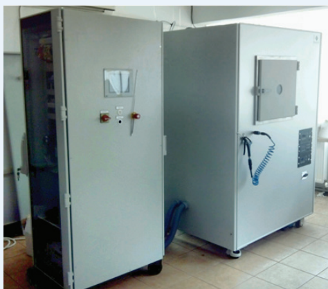
Fig. 59. Instalatie de plasma tip 400 CD roll-to-roll (Firma producatoare Europlasma din Belgia)
