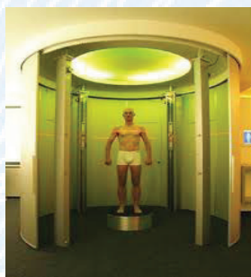
Fig. 58. Sistem mobil de masurare 3D automata a corpului (Firma producatoare Human Solutions GmbH din Germania)
