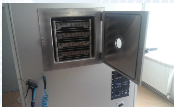
Fig. 41. – Incinta de vidare de la instalatia de plasma
