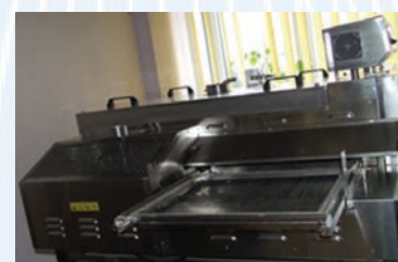
Aparat de uscare-termofixare-condensare-vaporizare (model TFO/S 500 mm) pentru operatii intermediare si finale de finisare superioara
