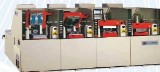
Fig. 60. Masina injectie ORCA bicolor (Firma producatoare Main Group din Italia)
