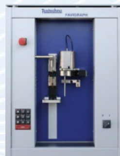
Fig. 55. Modul pentru determinarea rezistentei la tractiune a fibrelor textile (Firma producatoare Textechno din Germania)
