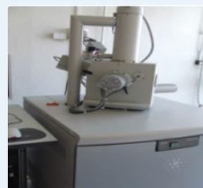
Fig. 56. Microscop electronic SEM (Firma producatoare FEI din Olanda)
