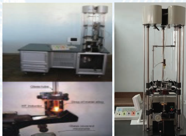
Fig. 45. - Echipament pentru obtinerea de microfilament din topitura de aliaje
