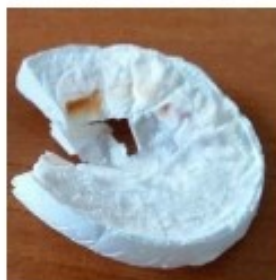
Fig. 4 - Structura densa, compacta, rigida. Se evidentiaza o pelicula in partea superioara.
