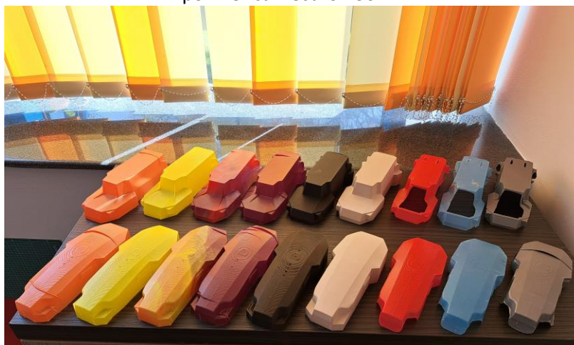
Figura 5. Produse-capace multicolore termoformate, împreună cu matrițele și cu cele 3 capace ce au fost montate anterior pe dronă
