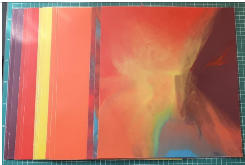
Figura 3. Plăci/folii procesate prin compoundare/presare termică utilizate pentru termoformarea capacelor realizate în diverse combinații cromatice
