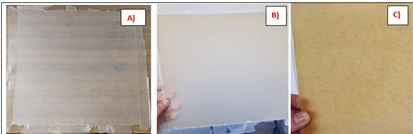
Figura 7. Plăci obținute prin metoda compresiei: A) PLA, B) PLA/fibre de lână netratate și C) PLA/cheratină
