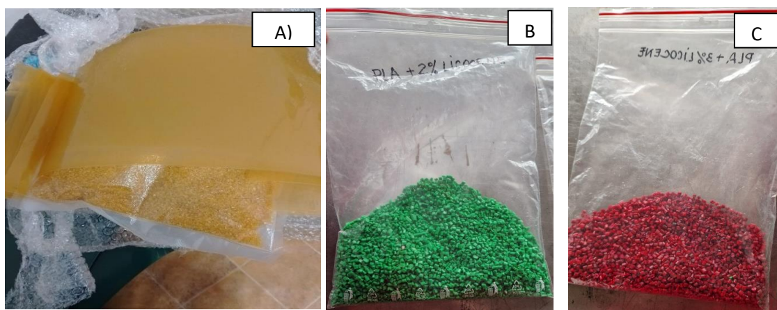
Figura 1. Mostre de PLA ignifugat sub formă de granule și folie (A) respectiv granule obținute prin extrudare-granulare pe baza de PLA modificat cu aditivi și coloranți (imaginile B și C)
