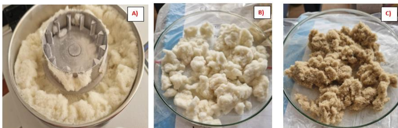
Figura 8. Fibre de lână Țurcană și Merinos tratate cu acid stearic (imaginile A și B) respectiv fibre de lână tratată cu Savinase/APTMS
